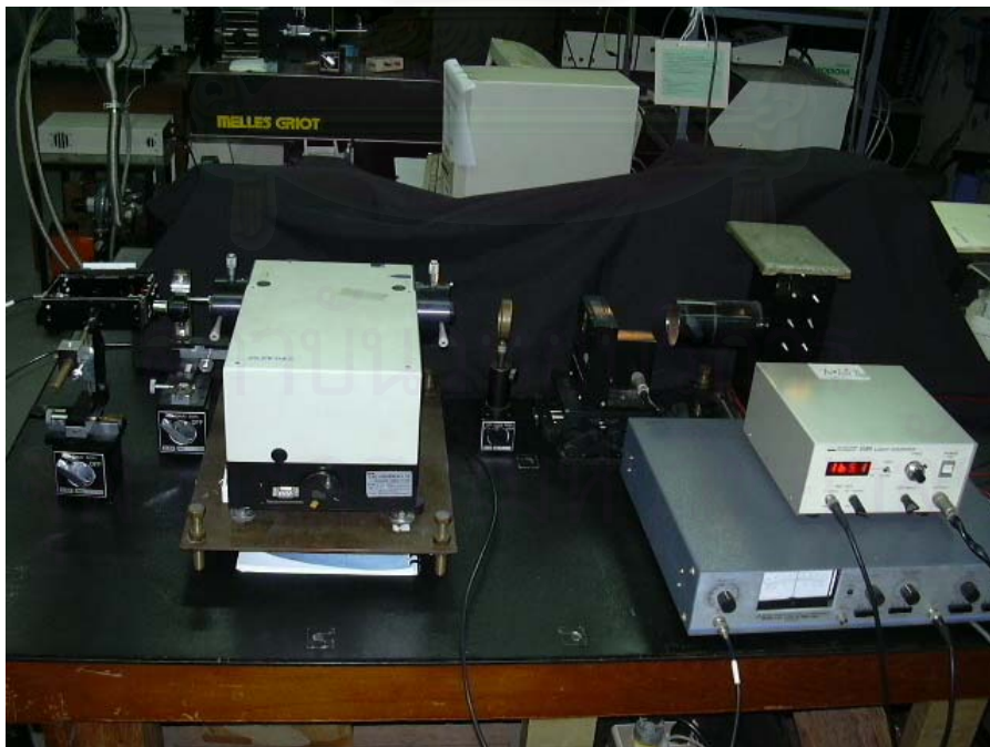
รูปที่ 5.11 ภาพถ่ายระบบการวัดสเปกตรัมผลตอบสนองต่อแสง ของเซลล์แสงอาทิตย์ชนิดอะมอร์ฟัส
