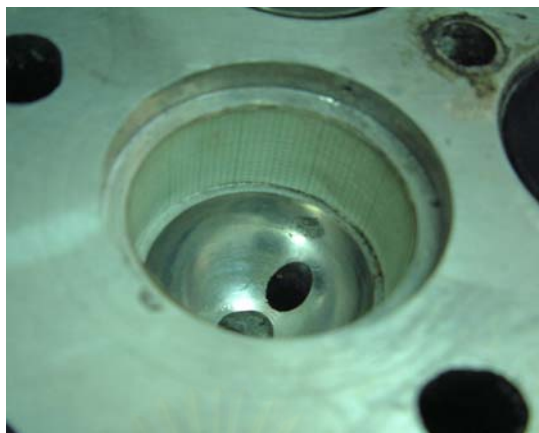
รูปที่ 5-19 การปรับเทียบขนาดของห้องเผาไหม้โดยการทำสเกลวัดระยะ
