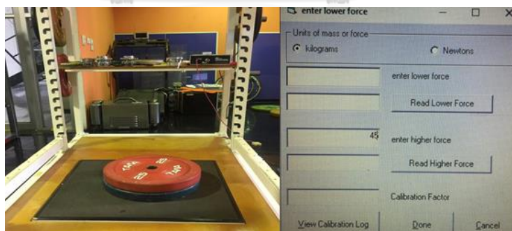
รูปที่ 20 วางแผ่นน้ำหนักเพิ่มลงไปบนแผ่นตรวจรับแรงกระแทก
