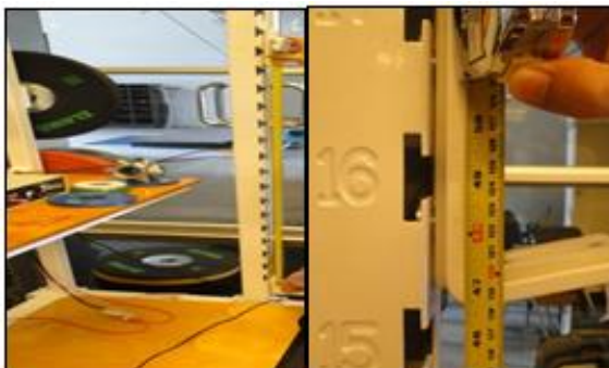
รูปที่ 21 แสดงการวัดระยะระหว่างตำแหน่งหมายเลข 1 และ 16 ด้วยตลับเมตร ได้ 120 เซนติเมตร
