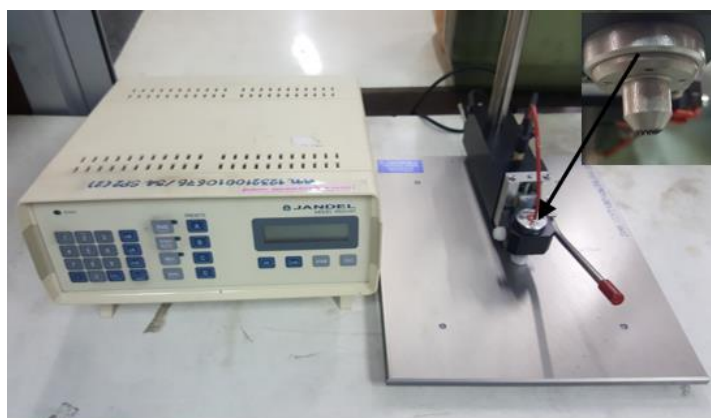
รูปที่ 3.3 four-point probe ของบริษัท JANDEL รุ่น RM3-AR
