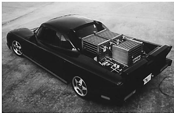
รูปที่ 2.6 Green Car รถยนต์คันแรกที่ขับเคลื่อนโดยเซลล์เชื้อเพลิงแบบชนิดเยื่อแลกเปลี่ยนโปรตอน [10]
