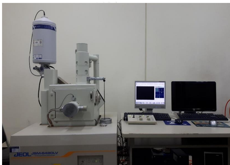
รูปที่ 3.10 กล้องจุลทรรศน์อิเล็กตรอนแบบส่องกราดยี่ห้อ JEOL รุ่น JSM-6480LV ที่ต่อกับดีเทคเตอร์เสริม energy dispersive X-ray spectrometer (SEM-EDX) ยี่ห้อ OXFORD INSTRUMENTS รุ่น 7573
