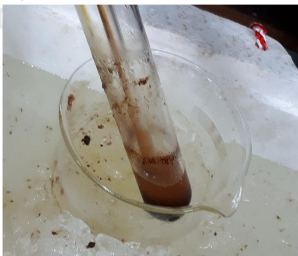
รูปที่ 3.4 ไอรระเหยจากการไพโรไลซิสที่ถูกควบแน่นอยู่ในถังน้ำแข็ง
