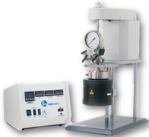
รูปที่ 3.1 เครื่องปฏิบัติการทนความดันสูงชนิดแบตช์ รุ่น Parr 4566 และเครื่องควบคุม รุ่น Parr 4848
