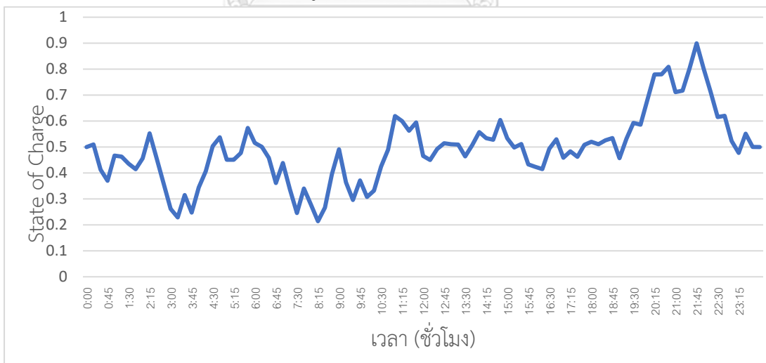
รูปที่ 3.28 ค่า SoC ของแบตเตอรี่ที่ได้จากการคำนวณใน 1 วัน
