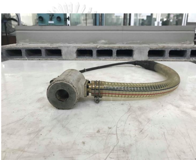
รูปที่ 3. 18 เครื่องมือวัดหน่วยแรง โหลดเซลล์
