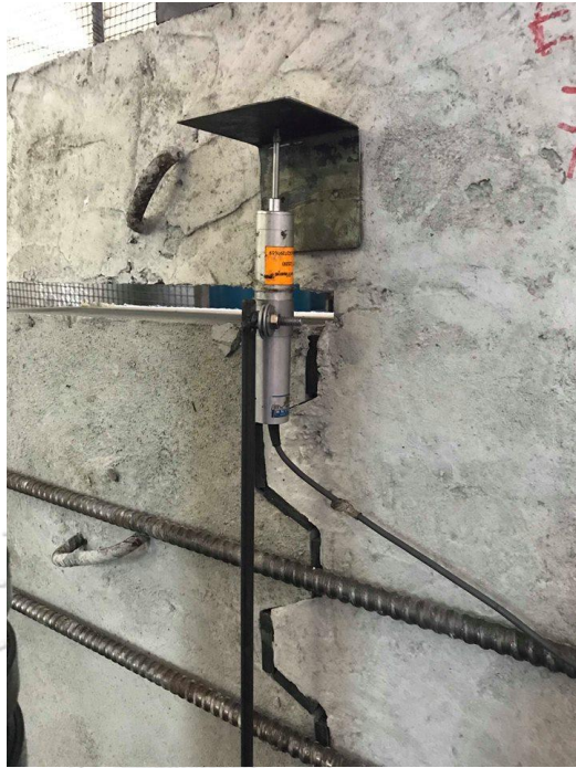
รูปที่ 3. 25 ติดตั้งเครื่องมือวัดการเคลื่อนตัวอย่างน้อยสองจุด
