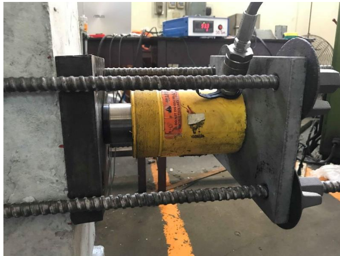
รูปที่ 3. 23 แม่แรงไฮดรอลิคดันโครงรับแรงให้เกิดแรงดันท่าง
