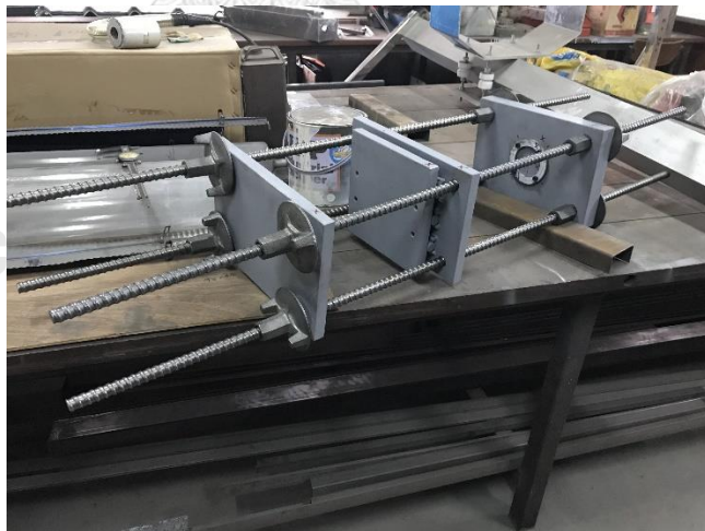
รูปที่ 3. 22 โครงรับแรงสำหรับอัดแรงด้านข้างชิ้นส่วนทดสอบ
