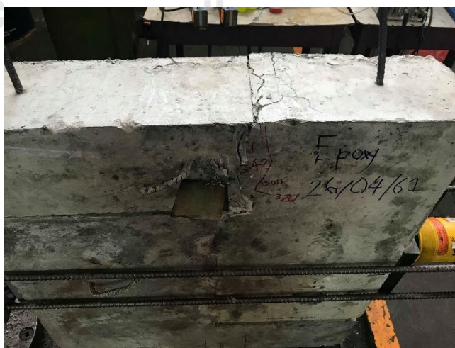
รูปที่ 4. 8 การวิบัติของชิ้นตัวอย่างทดสอบรอยต่ออีพ็อกซีด้านบนก่อนรอยต่อเกิดการวิบัติ
