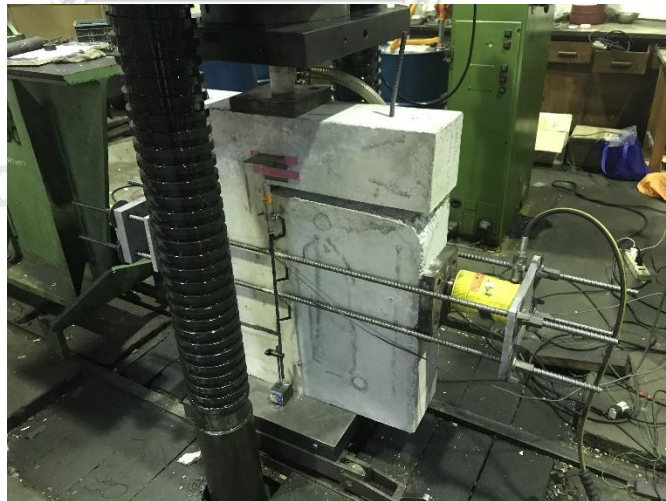
รูปที่ 3. 26 ชิ้นตัวอย่างทดสอบเข้าเครื่องมือทดสอบให้แรงกดอัดเพิ่มขึ้นคงที่
