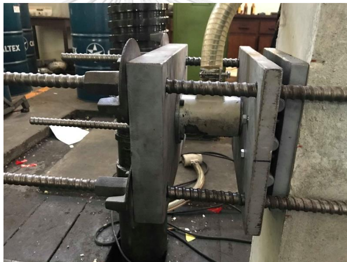
รูปที่ 3. 24 วัดแรงอัดดันท่างจากเครื่องมือวัดหน่วยแรง โหลดเซลล์
