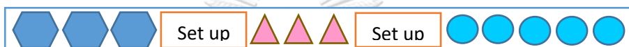
รูปที่ 2.7 สายงานการประกอบสำหรับหลายผลิตภัณฑ์ (Multi-Model Assembly Lines)
