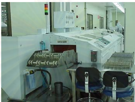
รูปที่ 17 แสดงเครื่อง Solvent Cleaning Machine
