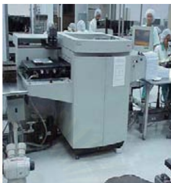
รูปที่ 13 แสดงเครื่องปาดตะกั่วแบบกึ่งอัตโนมัติ (Semi-Automation)
