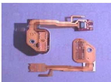
รูปที่ 9 ตัวอย่างผลิตภัณฑ์แบบที่ใช้ Pre- Amp แบบ SOP (Small Outline Pack)
