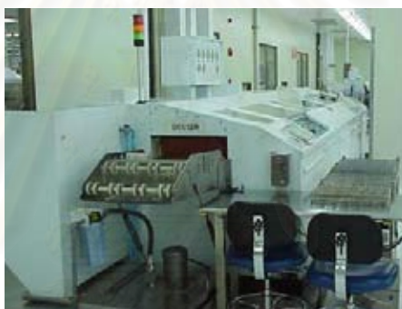
รูปที่ 38 แสดงเครื่องล้าง ( Aqueous Cleaning Machine)
