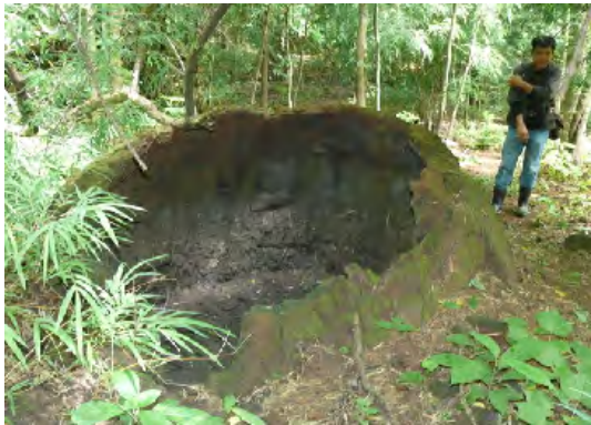
ภาพที่ 1. เตาเผาถ่านสร้างด้วยดิน ซึ่งเกษตรกรได้สร้างขึ้นในพื้นที่ป่าที่ทำการศึกษา
