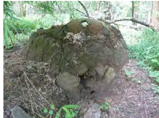
ภาพที่ 1. เตาเผาถ่านสร้างด้วยดิน ซึ่งเกษตรกรได้สร้างขึ้นในพื้นที่ป่าที่ทำการศึกษา
