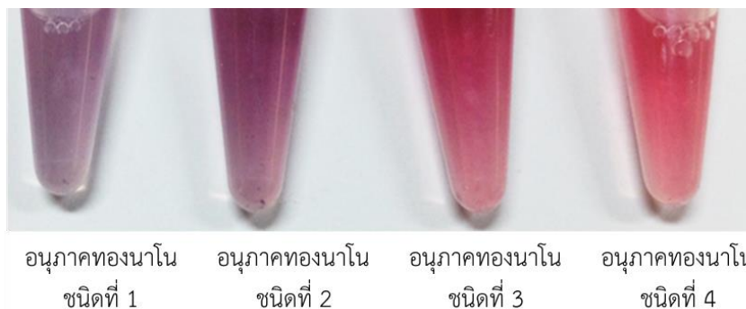
ภาพที่ 29 สีของอนุภาคทองคำนาโนที่สังเคราะห์ด้วย 1% โซเดียมซิเตรทในอัตราส่วนต่างๆ
