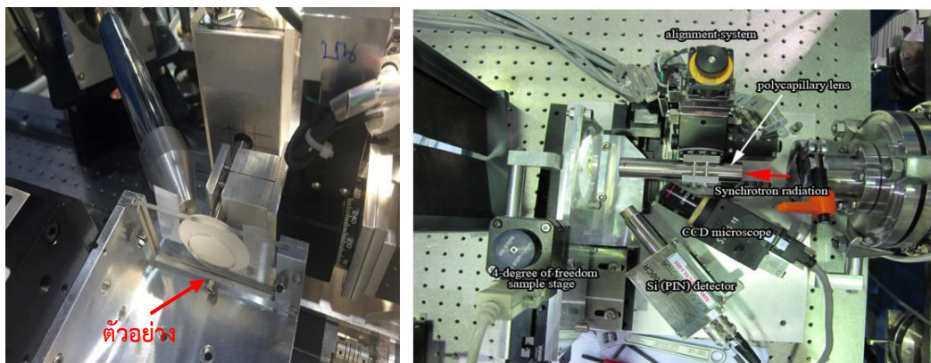
ภาพที่ 3.9 ภายในระบบลำแสง BL6b micro-X-ray fluorescence spectroscopy
