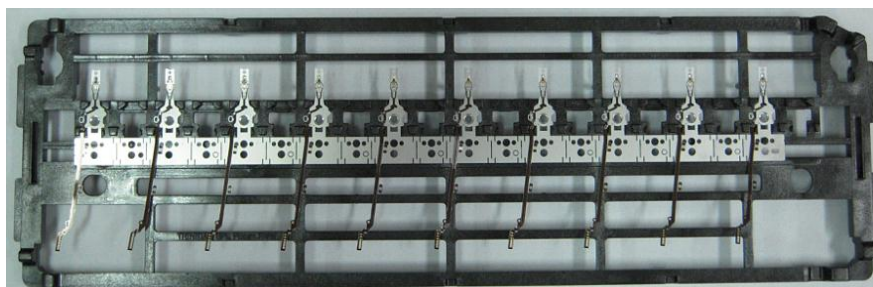
รูปที่ 6.3 เทรย์ใส่ชิ้นงาน ที่ได้รับการออกแบบใหม่
