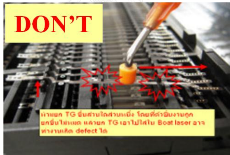
รูปที่ 6.18 การใช้เครื่องมือหยิบจับชิ้นงานไม่ถูกต้องของกระบวนการ Laser
