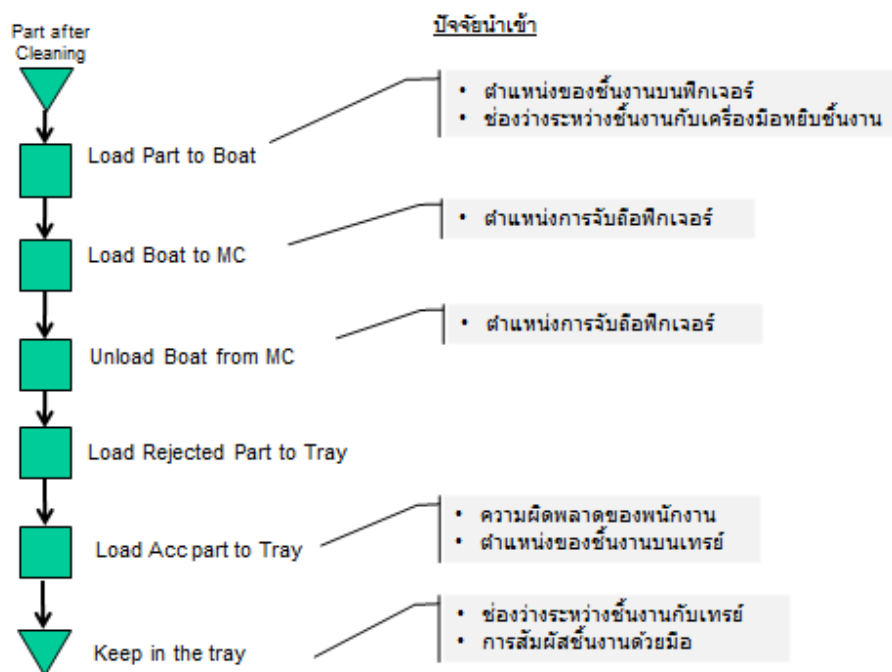
รูปที่ 4.11 แผนผังขั้นตอนการทำงานย่อยระบุปัจจัยนำเข้าของกระบวนการ Backend
