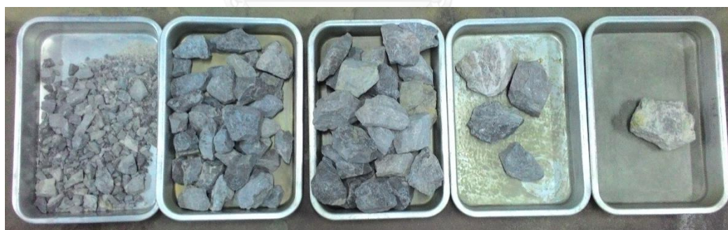
ภาพที่ ก.1 ขนาดตัวอย่างแร่โดโลไมต์ของพื้นที่เอ (ก) -1" +Pan (ข) -2" +1" (25 มิลลิเมตร) (ค) -3" +2" (50 มิลลิเมตร) (ง) -4" +3" (75 มิลลิเมตร) และ (จ) -5" +4" (100 มิลลิเมตร)
