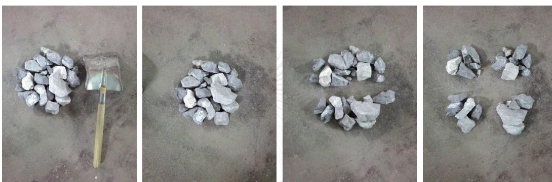
ภาพที่ ก.3 การซีกตัวอย่างแบบกรวยแบ่งสี่ (Cone and Quartering)
