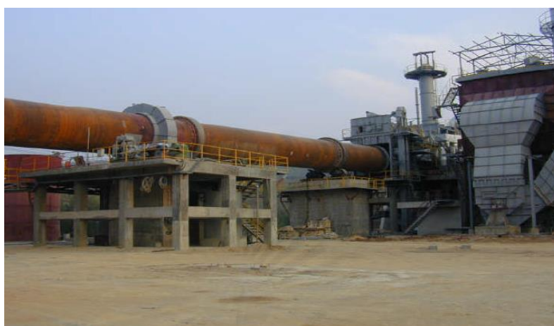
ภาพที่ 2.19 เตาแบบหมุน (Rotary Kiln) (นนทชัย อึ้งชัยพาณิชย์, 2546)
