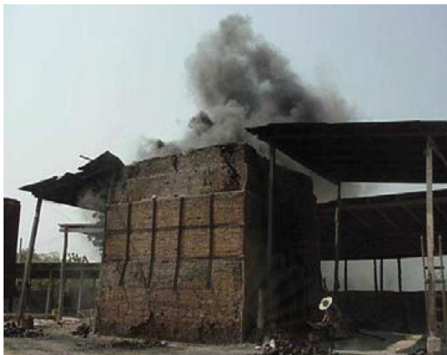
ภาพที่ 2.16 เตาแบบเผาทีละครั้ง (Batch Kiln) (นนทชัย อึ้งชัยพาณิชย์, 2546)
