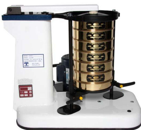
ภาพที่ ข.3 เครื่องคัดขนาดแบบสั่น (สมศักดิ์ สายสินธุ์ชัย, 2554)
