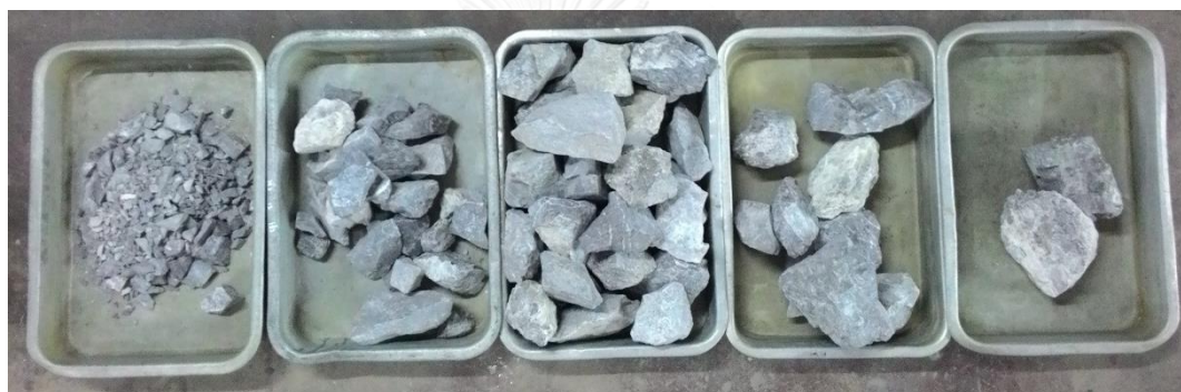
ภาพที่ ก.2 ขนาดตัวอย่างแร่โดโลไมต์ของพื้นที่เอ (ก) -1" +Pan (ข) -2" +1" (25 มิลลิเมตร) (ค) -3" +2" (50 มิลลิเมตร) (ง) -4" +3" (75 มิลลิเมตร) และ (จ) -5" +4" (100 มิลลิเมตร)
