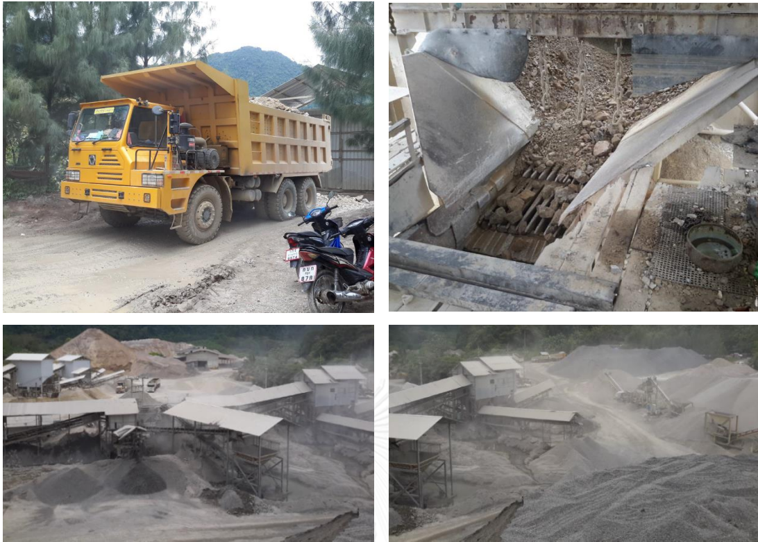
ภาพที่ ค.4 การขนส่งแร่โดยใช้รถบรรทุกเทท้าย และการผลิตแร่โดโลไมต์โดยวิธีทางกายภาพของ บริษัท ศิลาชัยสุราษฎร์ จำกัด
