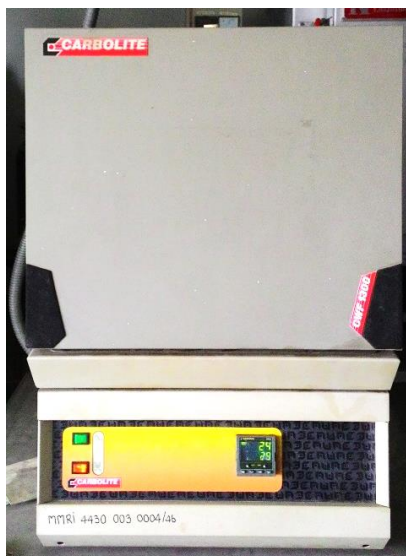
ภาพที่ 3.4 เตาเผาอุณหภูมิสูง ของ Carbolite รุ่น CWF 1300 ประเทศอังกฤษ ที่ใช้ในการเผาตัวอย่างแร่โดโลไมต์ ของสถาบันวิจัยโลหะและวัสดุ จุฬาลงกรณ์มหาวิทยาลัย
