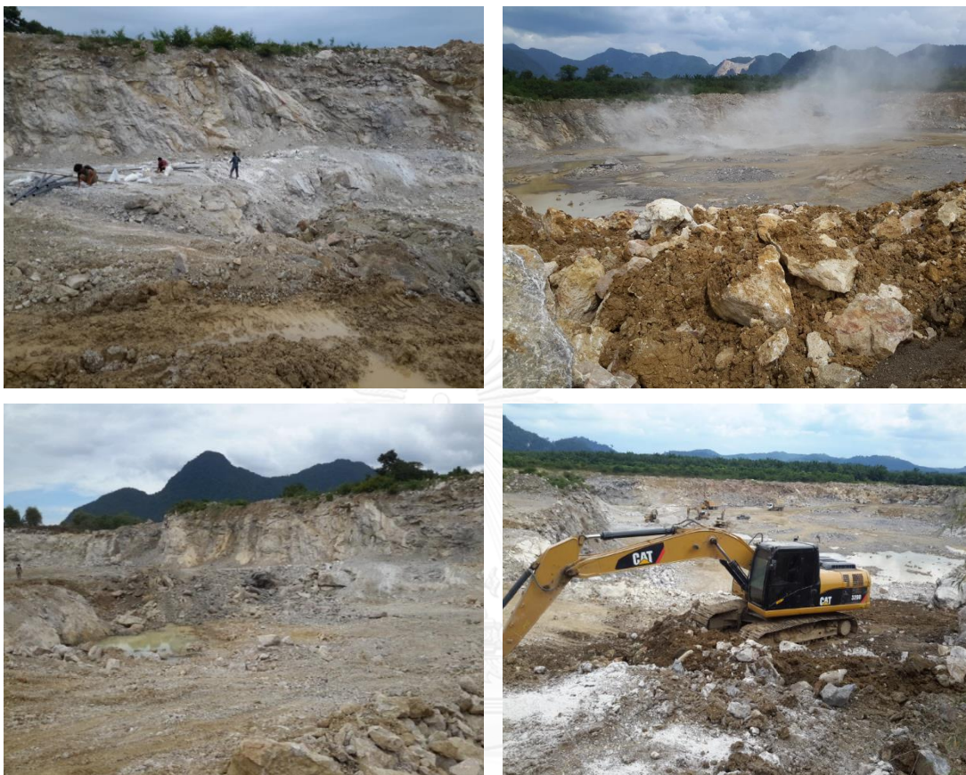
ภาพที่ ค.3 การระเบิดหน้าเหมืองแร่โดโลไมต์ และการขุดขนแร่โดโลไมต์ที่ได้หลังจากการระเบิดหน้าเหมืองแร่โดโลไมต์
