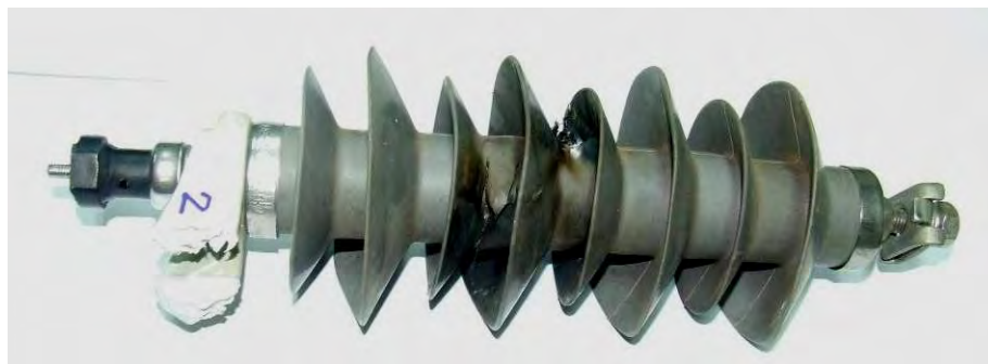
รูปที่ 5.4 ตัวอย่างกับดักเสิร์จที่มีการแตกหักของแขนฉนวน(Bracket)
