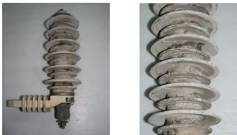
รูปที่ 6.4 สภาพภายนอกของตัวอย่างกับดักเสิร์จ PR-15A
