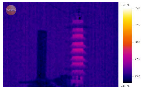
รูปที่ 6.10 กระแสรั่ว และภาพถ่ายความร้อนของตัวอย่างกับดักเล็รจ์BS-24C
