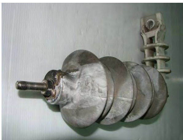
รูปที่ 5.3 ตัวอย่างกับดักเสิร์จที่พบการหลอมละลายของฝาครอบโลหะ และมีคราบเขม่าเป็นแนวยาวตามลำตัวของกับดักเสิร์จ
