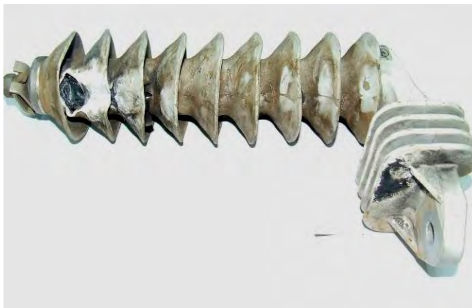
รูปที่ 5.2 ตัวอย่างกับดักเสิร์จที่มีการแตกของเปลือกพอลิเมอร์และภายในเกิดการเผาไหม้
