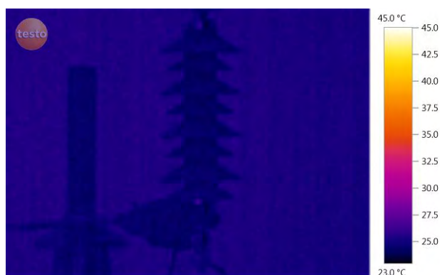
รูปที่ 5.26 ภาพถ่ายความร้อนตัวอย่าง SR-8C ขณะเริ่มต้นป้อนแรงดันระบบ 12.7 kV
