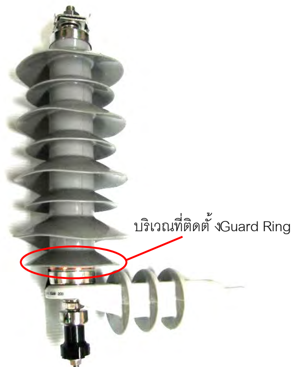
รูปที่ 4.16 การพันเทปทองแดงเป็นแหวนป้องกันกระแสรั่วตามผิว
