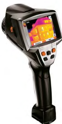
รูปที่ 4.20 กล้องถ่ายภาพความร้อนแบบอินฟราเรดที่ใช้ทดสอบวัตถุอุณหภูมิของกับดักเสิร์จ
