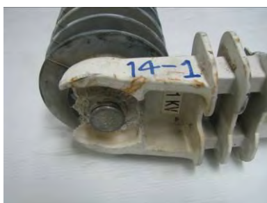
รูปที่ 4.5 ตัวอย่างอุปกรณ์ปลดวงจของกับดักเสิร์จผลิตภัณท์E (มีเฉพาะภาพตัวอย่างที่อุปกรณ์ปลดวงจกิดระเบิดไปแล้ว)
