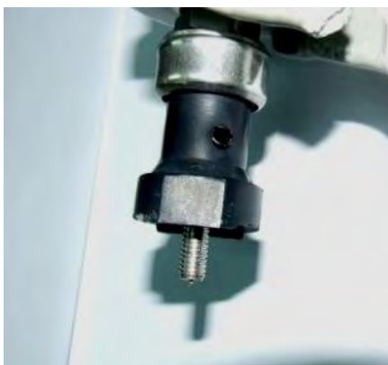
รูปที่ 5.5 ตัวอย่างกับดักเสิร์จที่พบว่าอุปกรณ์ปลดดวงจทำงานไม่สมบูรณ์
