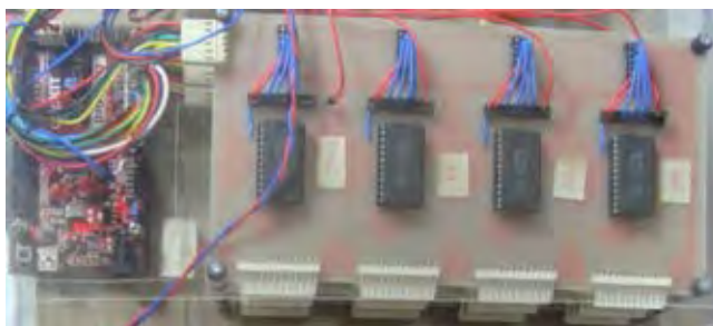
รูปที่ 3.7 CD4067BE 16-bits multiplexer จำนวน 12 ตัว (ซ้าย) ต่อกับไมโครคอนโทรลเลอร์ (ขวา)
