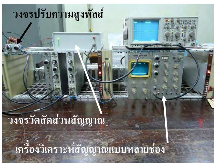
ภาพที่ 4.18 การจัดอุปกรณ์ทดสอบระบบวัดตำแหน่งสัดส่วนสัญญาณ
