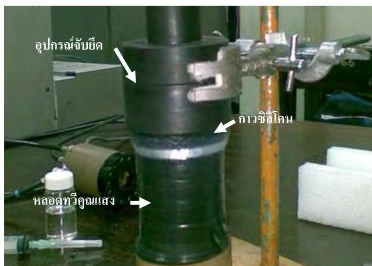
ภาพที่ 3.7 การประกอบอุปกรณ์เชื่อมต่อด้านหลอดทวิคูณแสง
