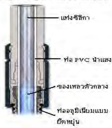
ภาพที่ 2.12 โครงสร้างของท่อนำแสงชนิดของเหลว
