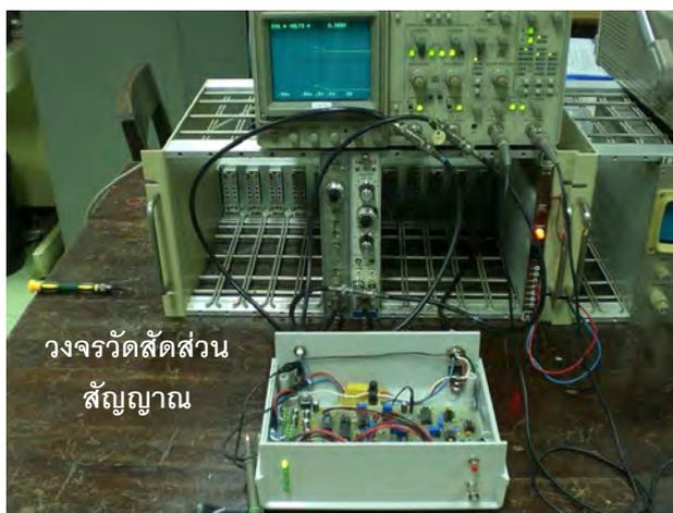
ภาพที่ 4.11 การจัดอุปกรณ์ทดสอบวงจรตรวจจับสัญญาณพัลส์
