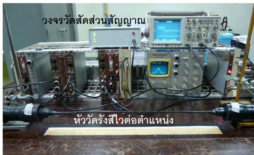
ภาพที่ 4. 22 การจัดระบบวัดรังสีเพื่อทำการทดสอบหัววัดรังสีแบบไวต่อตำแหน่ง
