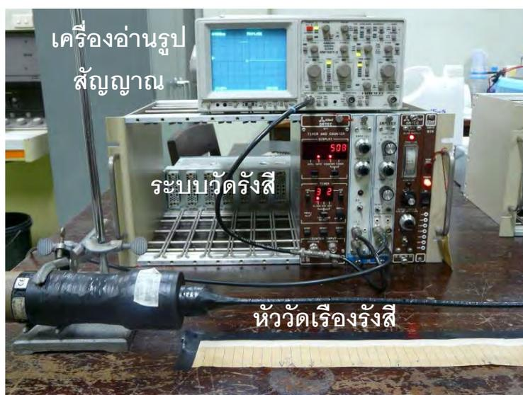
ภาพที่ 4.2 การจัดระบบวัดรังสีเพื่อทดสอบหัววัดเรืองรังสีแบบท่ออ่อนแกนเดี่ยว
