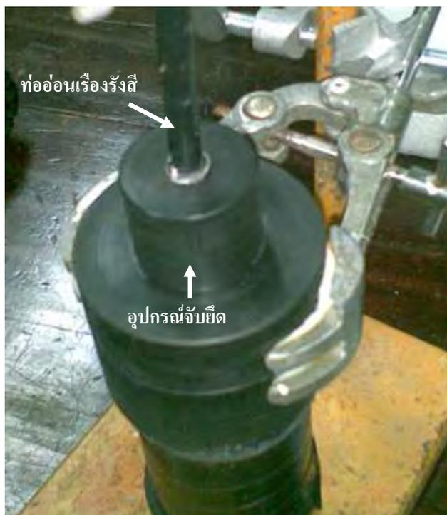
ภาพที่ 3.8 การประกอบอุปกรณ์เชื่อมต่อด้านปลายท่อเรื่องรังสี
