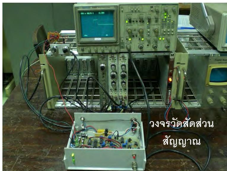
ภาพที่ 4.15 การจัดอุปกรณ์ทดสอบการทำงานของวงจรหารสัญญาณ
