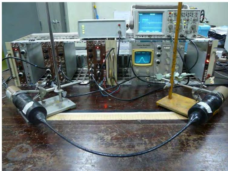
ภาพที่ 4.30 การจัดระบบวัดรังสีเพื่อทำการทดสอบหัววัดรังสีแบบไวต่อตำแหน่งในแนวโค้ง
