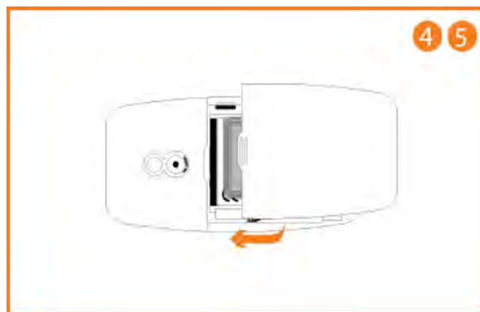
ภาพที่ 2-7: วิธีการใส่ TOUCH SIM Antenna Type A
