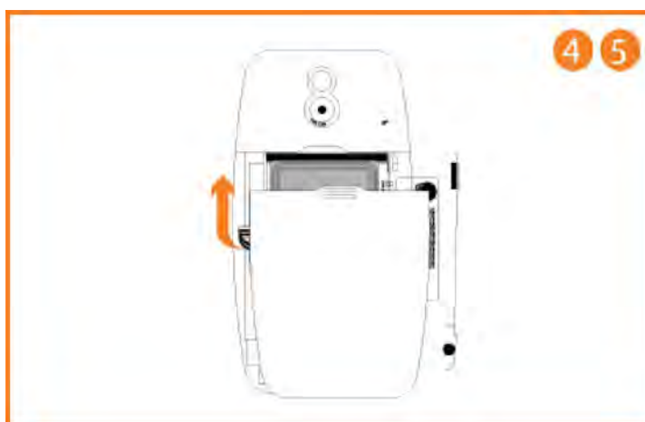
ภาพที่ 2-8: วิธีการใส่ TOUCH SIM Antenna Type D
