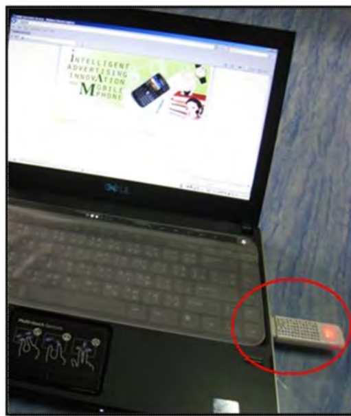
ภาพที่ 4-35: อุปกรณ์ air card ที่ทำหน้าที่เป็น SMS Gateway
