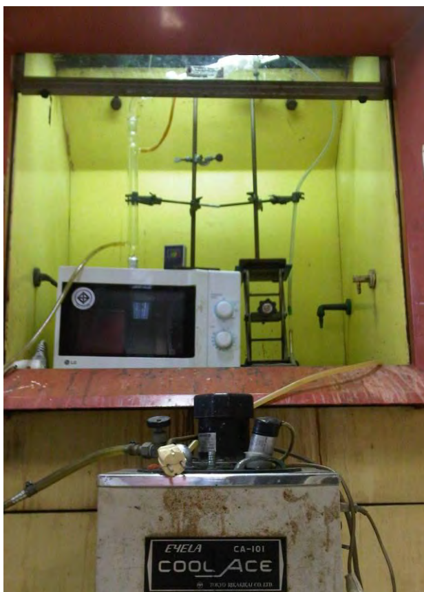
รูปที่ 3.2 ตู้อบไมโครเวฟที่ดัดแปลงเป็นพิเศษเพื่อใช้ในการทำปฏิกิริยา
