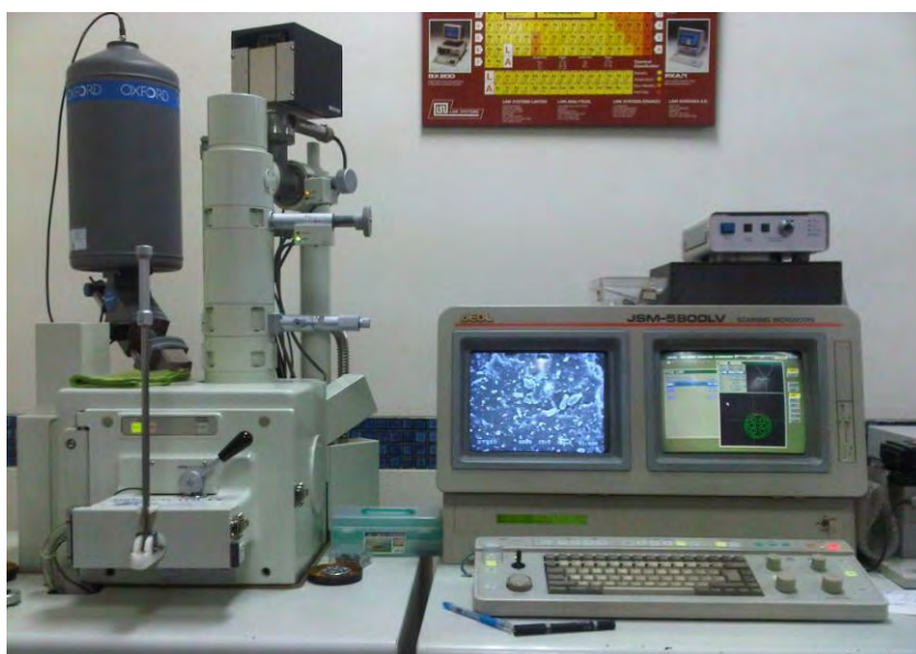
รูปที่ 3.8 กล้องจุลทรรศน์อิเล็กตรอนแบบส่องกราด
