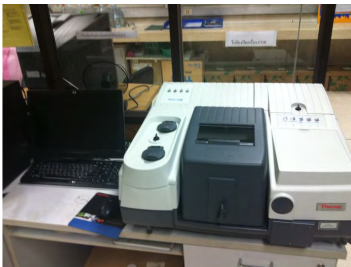
รูปที่ 3.3 ฟูเรียร์ทรานส์ฟอร์มสเปกโทรมิเตอร์
