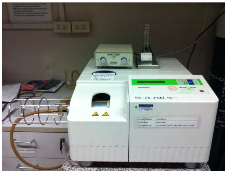
รูปที่ 3.6 เครื่องวิเคราะห์น้ำหนักภายใต้ความร้อน
