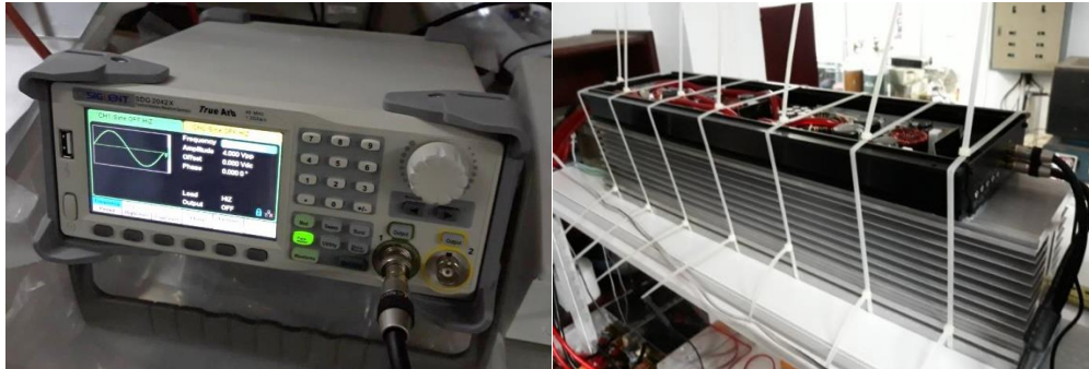
เครื่องกำเนิดสัญญาณ (Sine Wave Generator) เครื่องขยายสัญญาณ (Amplifier)
