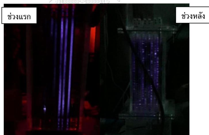
รูปที่ 19 ความหนาแน่นของพลาสมาที่ผลิตได้ด้วยระบบจ่ายไฟที่สร้างขึ้นก่อนเริ่มการทดลอง
