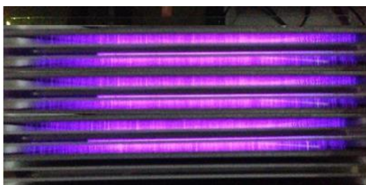
รูปที่ 19 ความหนาแน่นของพลาสมาที่ผลิตได้ด้วยระบบจ่ายไฟที่สร้างขึ้นก่อนเริ่มการทดลอง
