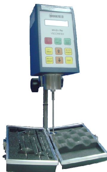
รูปที่ 3.4 มาตรฐานวัดความหนืดแบบบรู๊คฟิลด์
