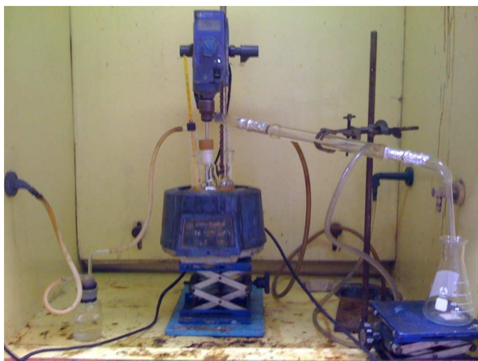
รูปที่ 3.3 อุปกรณ์การสังเคราะห์ยูรีเทนออยล์
