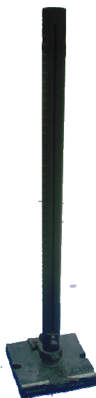
รูปที่ 3.8 เครื่องวัดความทนทานต่อแรงกระแทก
