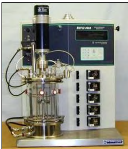
รูปที่ 2.3 ถังหมักทรงกระบอกขนาด 5 ลิตร (www.firstenbergequip.com., 2552 : ออนไลน์)
