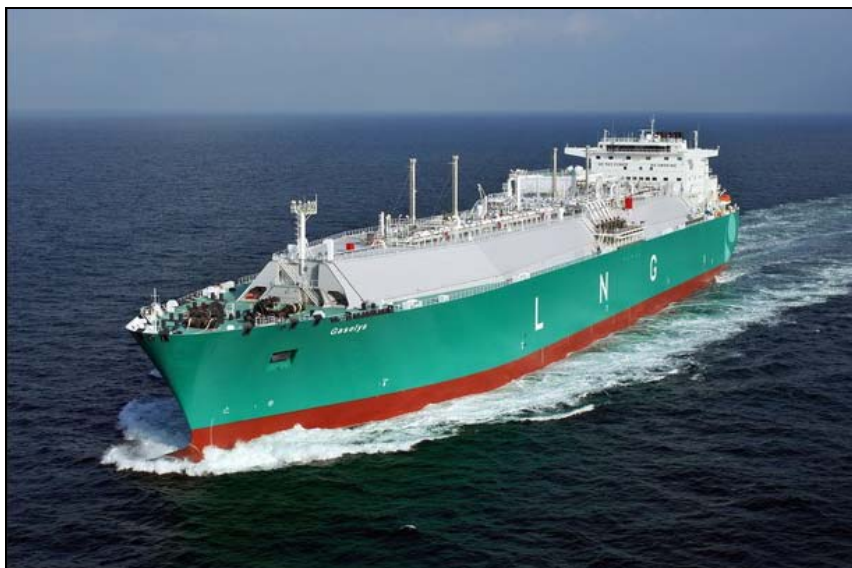
ภาพที่ 2.1 เรือบรรทุกก๊าซปิโตรเลียมเหลว LNG (Liquified Natural Gas)
