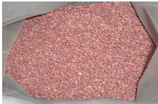
ภาพที่ 4.1 กากซีลีกา-อะลูมินาก่อนทำการปรับปรุงเบื้องต้น
