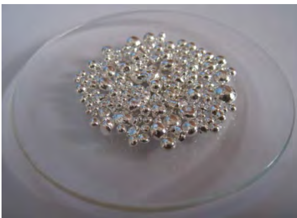
รูปที่ 2.2 แสดงถึงโลหะเงิน (silver) ที่ใช้เป็นสารตั้งต้นในการผลิตซิลเวอร์ซัลเฟต
