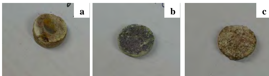
รูปที่ 2.30 การผลิตโฟมเงินโดยใช้ตัวสร้างโพรงอากาศ (space holder) ชนิดต่างๆ โดย a) กลีอกแคงเป็นตัวสร้างโพรงอากาศ b) คาร์โบไมด์เป็นตัวสร้างโพรงอากาศ และ c) น้ำตาลเป็นตัวสร้างโพรงอากาศ [26]
