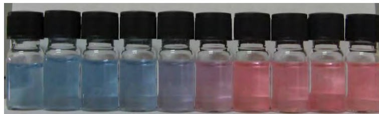
รูปที่ 2.2 การเปลี่ยนสีของพอลิไดแอเซทิลีนเวสิเคิลเมื่อได้รับการกระตุ้นจากความเป็นกรด-เบส
