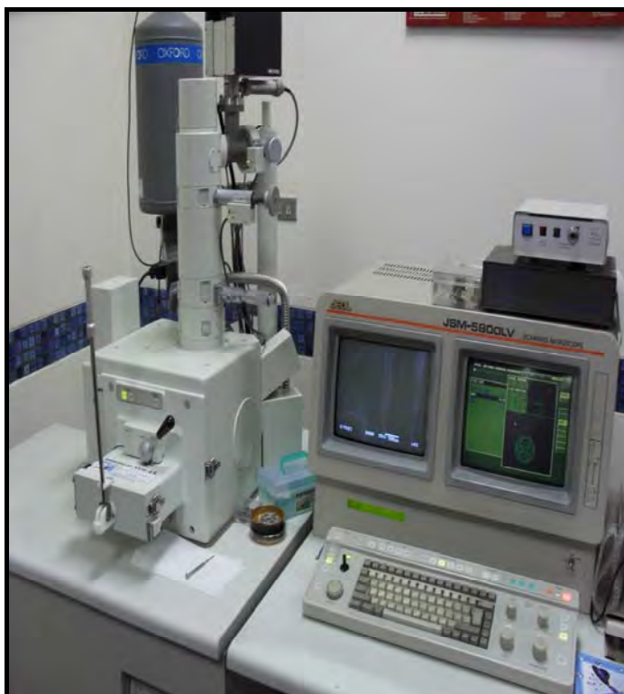
รูปที่ 3.11 กล้องจุลทรรศน์อิเล็กตรอนแบบส่องกราด
