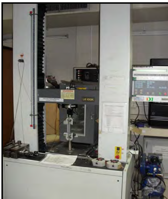
รูปที่ 3.6 เครื่องทดสอบยูนิเวอร์แซล (LLOYD รุ่น LR 100K)
