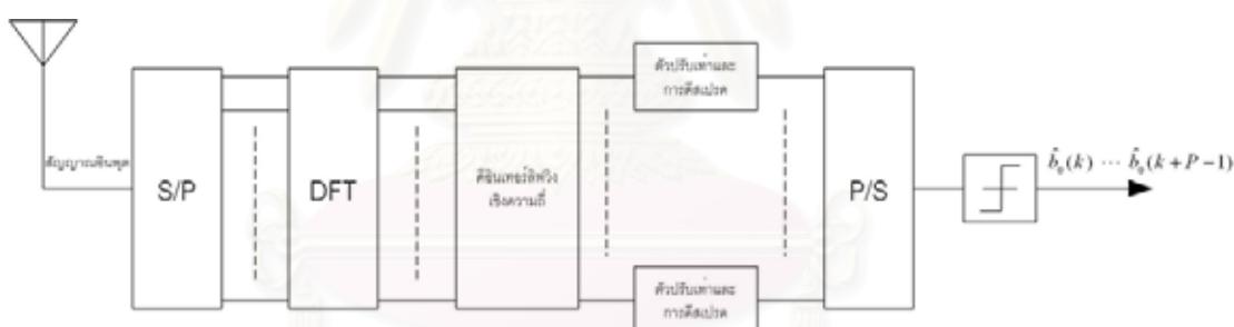
รูปที่ 2.20 เครื่องรับซีดีเอ็มเอหลายคลื่นพาหีแบบเบสแบนด์ซึ่งสอดคล้องกับเครื่องส่งซีดีเอ็มเอหลายคลื่นพาหีในรูปที่ 2.18(ก)
