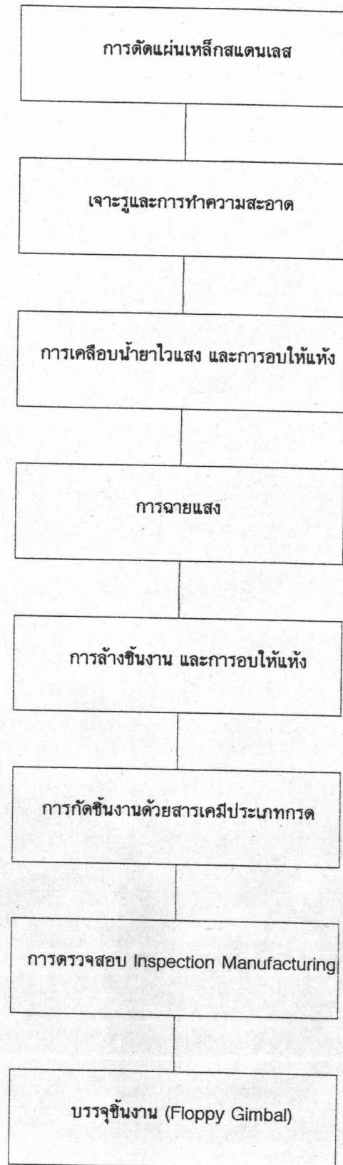
รูปที่ 2.8 แสดงขั้นตอนการผลิต ผลิตภัณฑ์ Etching
