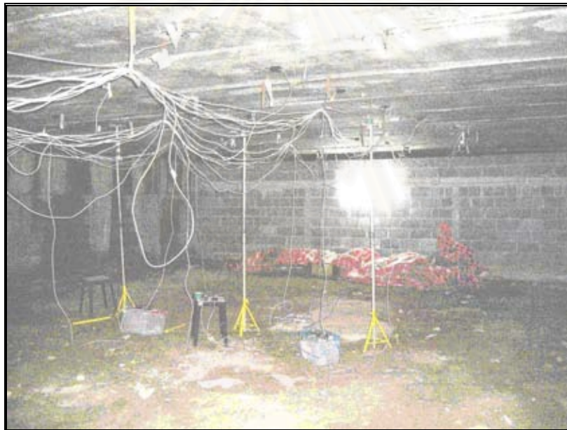
รูปที่ 6.11 การทดสอบภาคสนามการเก็บวัดการแอมตัวและความเครียดเพื่อแปลงความเครียดเป็นการแอมตัว
