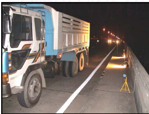
รูปที่ 6.28 ขั้นตอนการทดสอบขณะรถบรรทุกเคลื่อนที่ออกจากสะพาน
