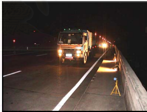
รูปที่ 6.27 ขั้นตอนการทดสอบขณะรถบรรทุกเริ่มเคลื่อนที่เข้าสะพาน
