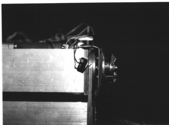
รูปที่ ก.3 แสดงตำแหน่งที่ติดตั้งของไมโครสวิตซ์ป้องกันการเคลื่อนที่เกินขีดจำกัด
