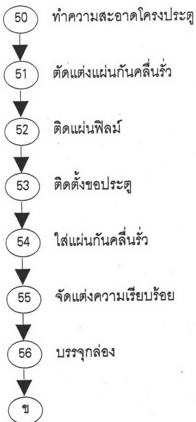
รูปที่ 3.13 กระบวนการประกอบชิ้นส่วนเตาอบไมโครเวฟ
