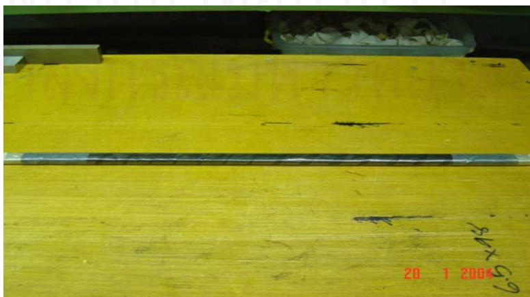
รูปที่ 4.15 แท่งสเตเตอร์ที่พันฉนวนเรียบร้อยแล้วพร้อมเข้าเครื่องบีบอัดด้วยความร้อน
