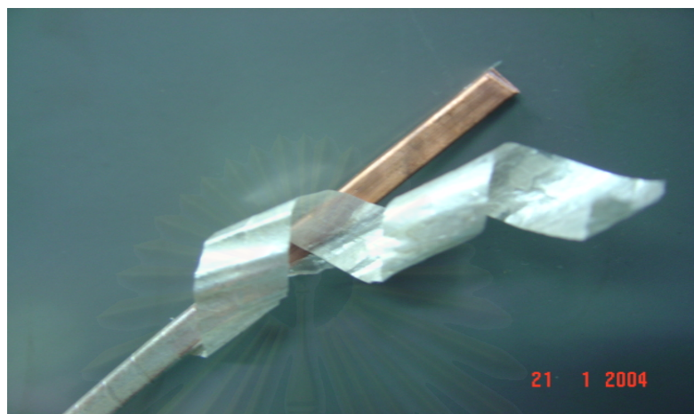
รูปที่ 4.4 ลวดทองแดงหุ้มด้วยฉนวนไมก้า
