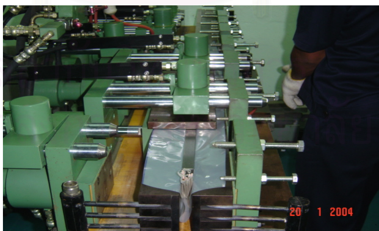
รูปที่ 4.13 การบีบอัดฉนวนด้วยความร้อน ครั้งที่ 1
