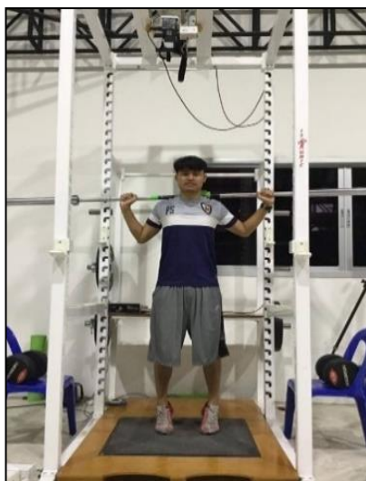
รูปที่ 24 แสดงผู้ทดสอบยืนแบกบาร์เบลผ่านแผ่นตรวจรับแรงกระแทก ของเครื่อง Ballistic Measurement system
