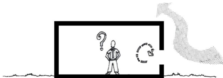
รูปที่ 2-11 แสดงการไหลของลมเมื่อมีช่องเปิดด้านเดียว (ที่มา : ตรึงใจ บุรณสมภพ, 2539)
