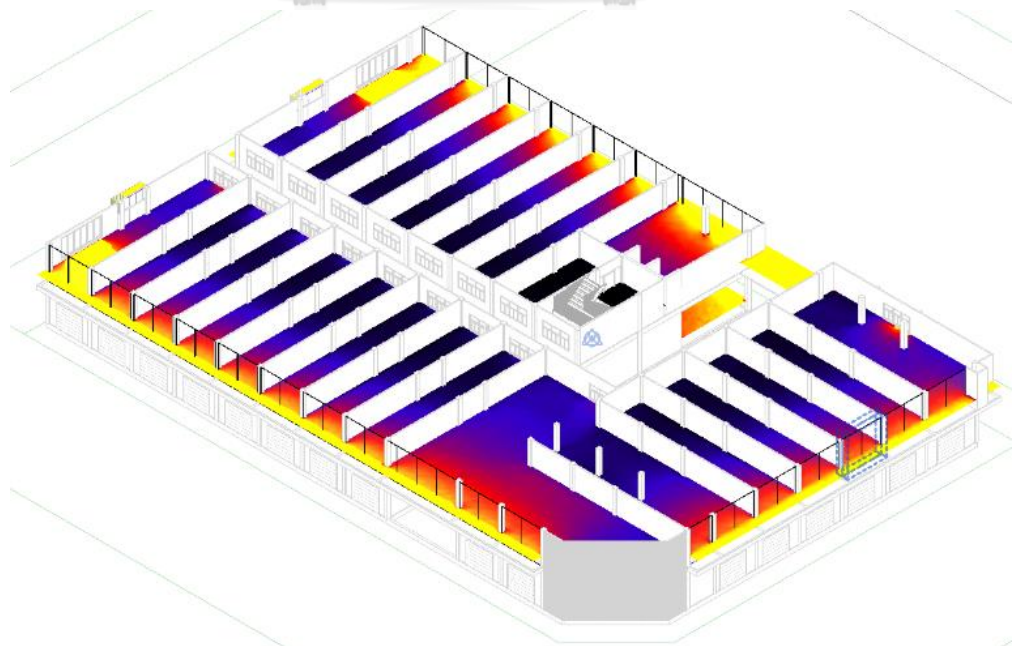
รูปที่ 85 การคำนวณแสงสว่างที่เข้ามาในอาคารของวัสดุผนังใหม่ที่เป็นกระจก
