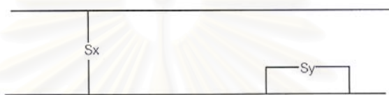
รูปที่ 2.4 การเชื่อมขวางโมเลกุลของยางด้วยกำมะถัน
