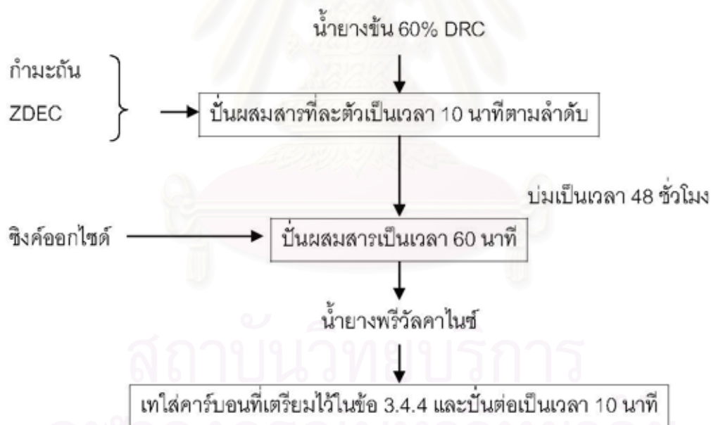
รูปที่ 3.6 ขั้นตอนการผสมน้ำยางผสมคาร์บอน
