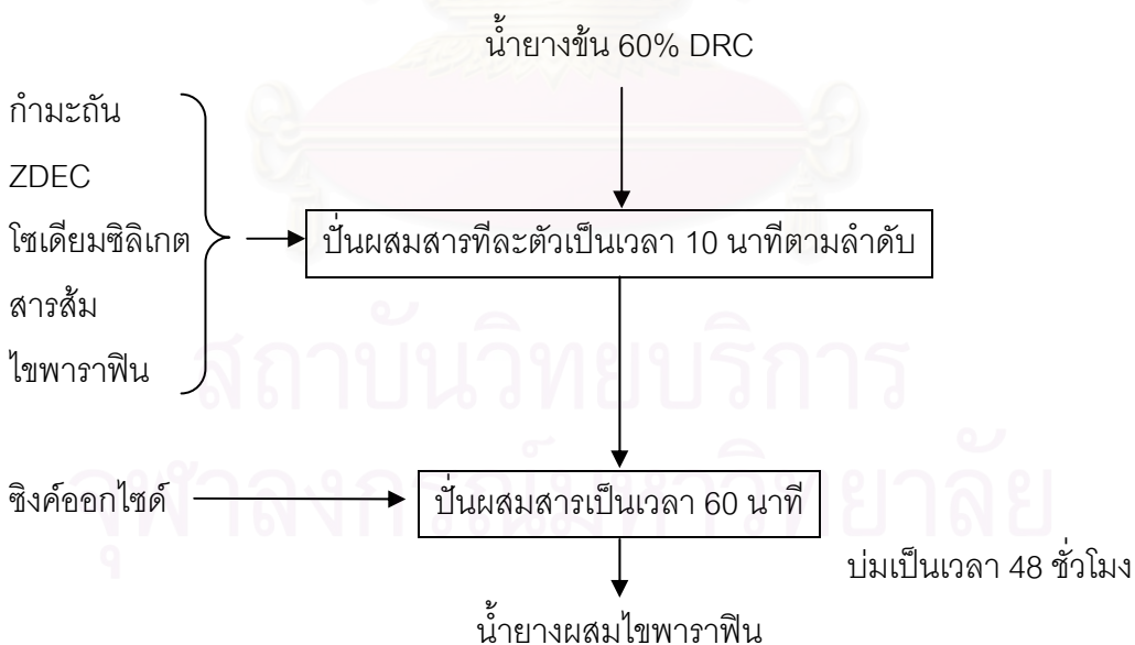
รูปที่ 3.5 ขั้นตอนการผสมน้ำยางผสมไซพาราฟิน
