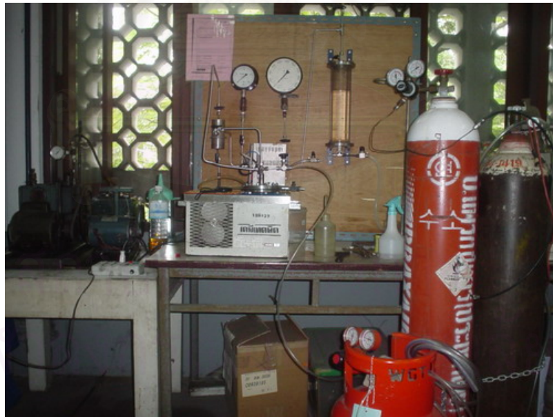
รูปที่ 3.4 ชุดอุปกรณ์การทดลองดูดซับแก๊สเชื้อเพลิง
