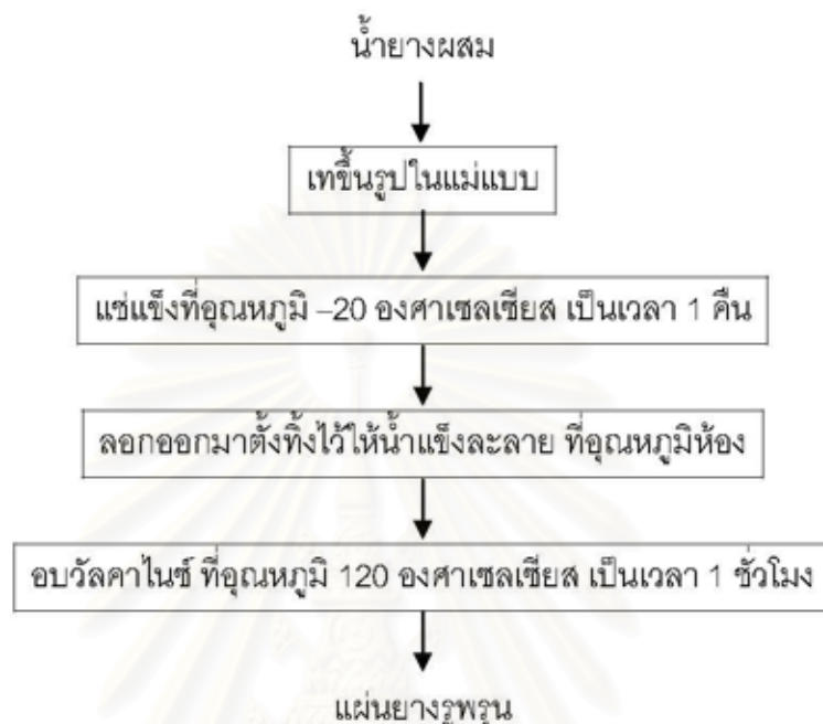
รูปที่ 3.7 แสดงขั้นตอนการเตรียมตัวอย่างแผ่นยางพรม
