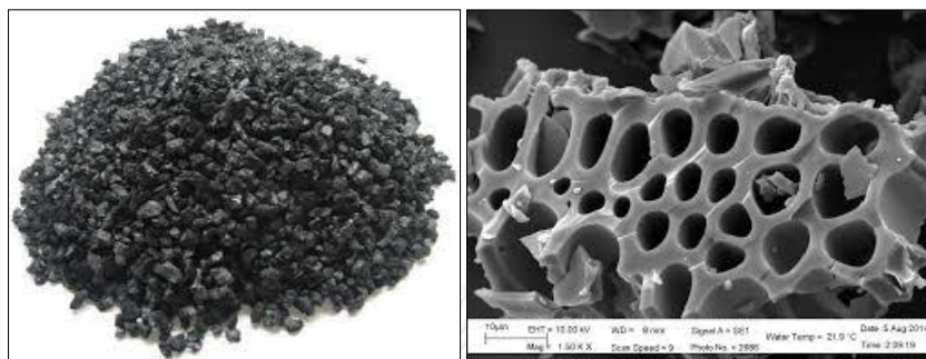
รูปที่ 2.8 ภาพถ่านกัมมันต์ และภาพถ่ายกล้องจุลทรรศน์อิเล็กตรอนแบบส่องกราดของถ่านกัมมันต์ [14]
