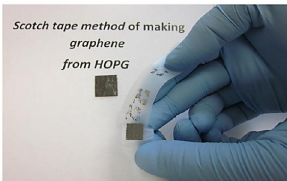
รูปที่ 2.10 การสังเคราะห์แกรฟีนด้วยวิธี Mechanical exfoliation [12]
