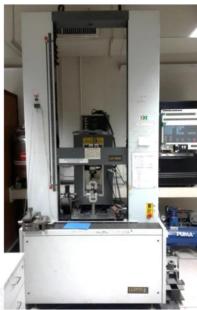
รูปที่ 3.19 เครื่อง Universal testing machine ของ LLOYD รุ่น LR100K
