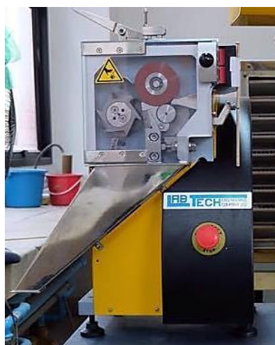
รูปที่ 3.9 เครื่องตัดเม็ดพลาสติกของ Labtech Engineering รุ่น LZ-80/VS
