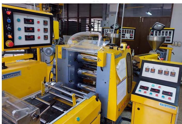
รูปที่ 3.10 เครื่องรีดหล่อฟิล์มของ Labtech Engineering รุ่น LCR-300HDCO-EX
