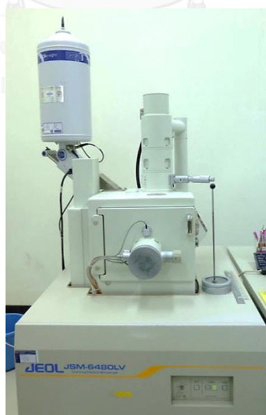
รูปที่ 3.14 เครื่อง Scanning Electron Microscope บริษัท JEOL รุ่น JSM-6400LV
