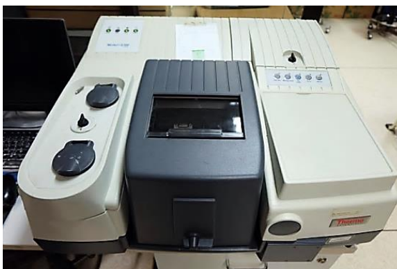
รูปที่ 3.12 เครื่อง Fourier Transform Infrared Spectrometer ของ Thermo Scientific รุ่น Nicolet 6700
