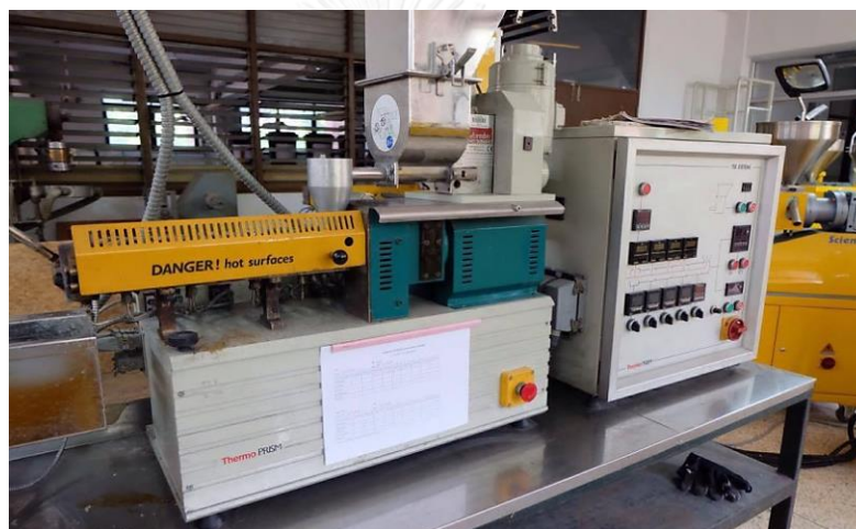
รูปที่ 3.8 เครื่องอัดรีดสกรูคู่ของ Thermo Prism รุ่น DSR-28
