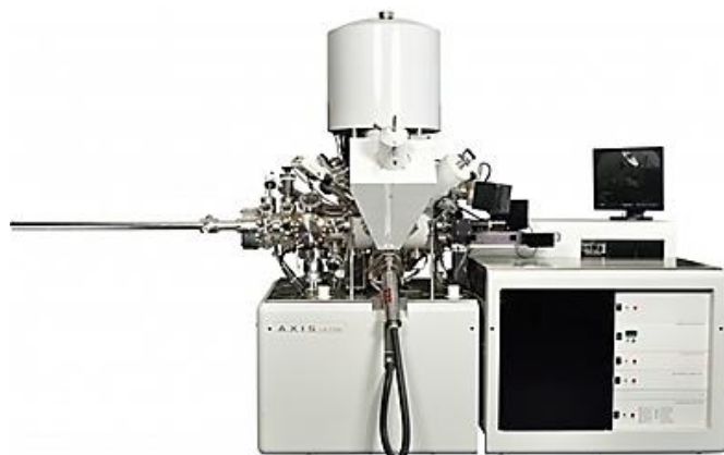
รูปที่ 3.13 เครื่อง X-ray photoelectron spectroscopy ของ Kratos Analytical รุ่น AXIS Ultra DLD [31]
