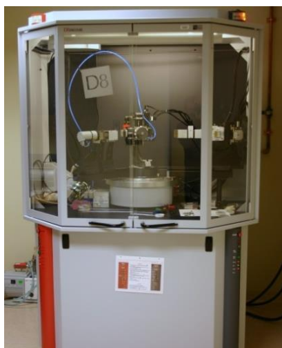
รูปที่ 3.15 เครื่อง X-ray diffraction ของ Bruker รุ่น D8 Advance
