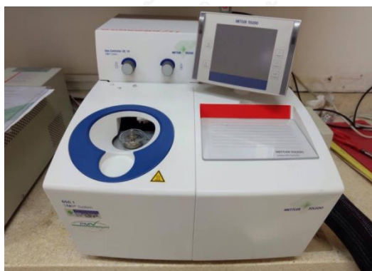
รูปที่ 3.18 เครื่อง Differential Scanning Calorimetry ของ Mettler Toledo รุ่น DSC1/STAR e
