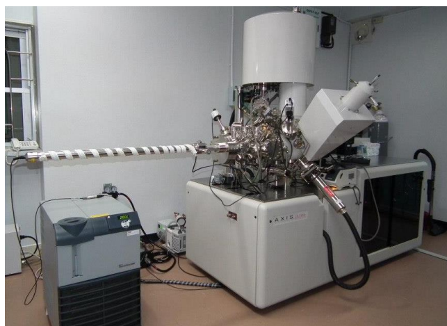
รูปที่ 3.12 เครื่องเอกซเรย์โฟโตอิเล็กตรอนของ Kratos analytical รุ่น Axis Ultra DLD
