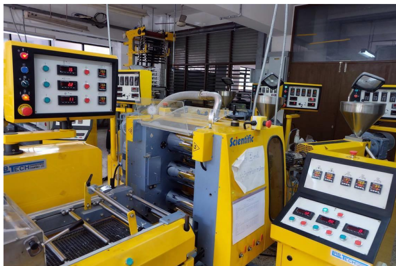
รูปที่ 3.7 เครื่องรีดหล่อฟิล์มของบริษัท Labtech Engineering รุ่น LCR-300HDCO-EX/VS
