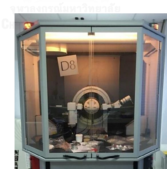
รูปที่ 3.10 เครื่องวิเคราะห์การเลี้ยวเบนรังสีเอกซ์ของ Bruker รุ่น D8 Advance
