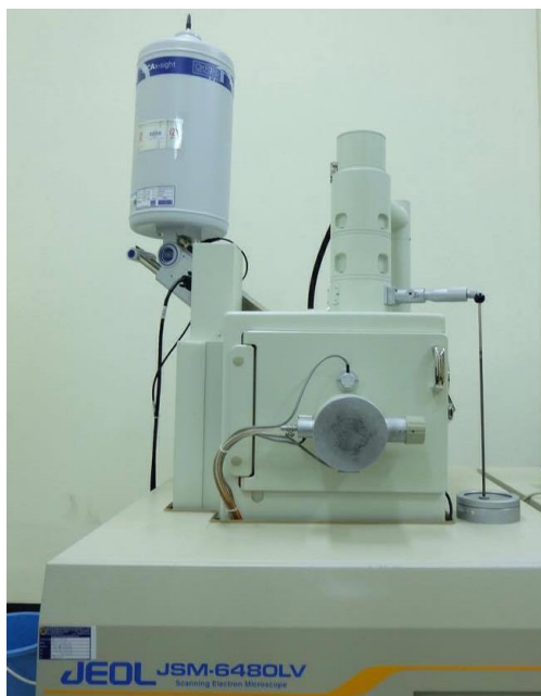
รูปที่ 3.9 กล้องจุลทรรศน์อิเล็กตรอนแบบส่องกราดของบริษัท JEOL รุ่น JSM-6400LV
