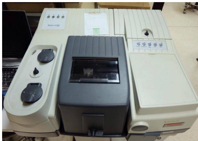
รูปที่ 3.11 เครื่องฟูเรียร์ทรานส์ฟอร์มอินฟราเรดสเปกโทรโฟโตมิเตอร์ของ Thermo scientific รุ่น Nicolet 6700
