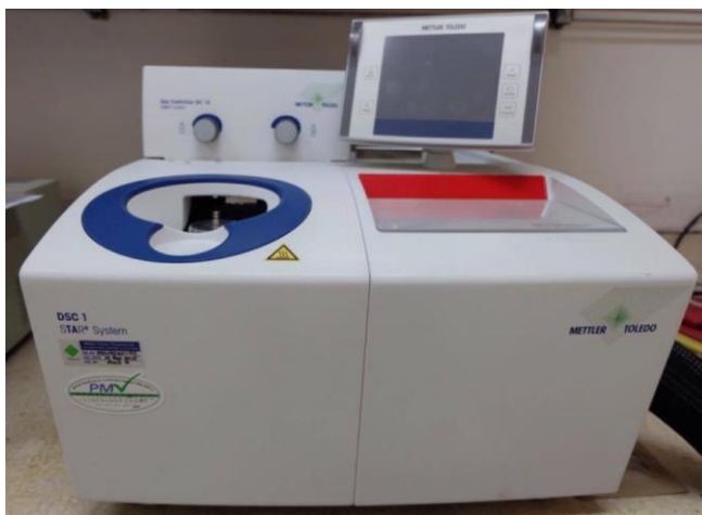
รูปที่ 3.13 เครื่องดีฟเฟอเรนเชียลสแกนนิ่งแคลอริเมทรีของบริษัท Mettler Toledo รุ่น DSC1/STARe
