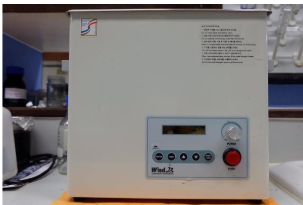
รูปที่ 3.4 เครื่องอัลตราโซนิกของบริษัท Nisd laboratory instruments รุ่น WUC-D06H
