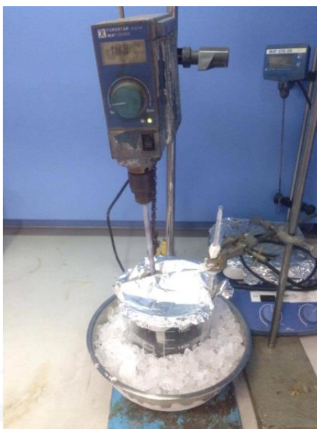
รูปที่ 3.1 การสังเคราะห์แกรไฟีนออกไซด์จากแกรไฟต์ภายใต้อ่างน้ำแข็ง
