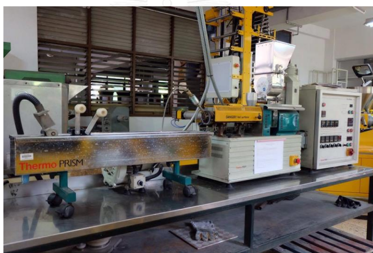
รูปที่ 3.5 เครื่องอัดรีดสกรูคู่ของบริษัท Thermo Prism รุ่น DSR-28
