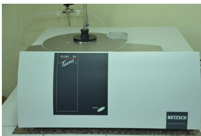
รูปที่ 3.14 เครื่องวิเคราะห์น้ำหนักภายใต้ความร้อนของ Netzsch รุ่น TG 209 F3 Tarsus
