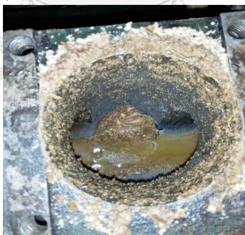
รูปที่ 4.6 น้ำมันเมล็ดมะรุมแบบกระเพาะเปลือกที่ติดภายในเครื่องอัดสกรูเดี่ยวหลังการบีบอัด
