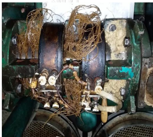
รูปที่ 4.5 กากเมล็ดมะรุมแบบกระเพาะเปลือกที่ติดภายในเครื่องอัดสกรูเดี่ยวหลังการบีบอัด
