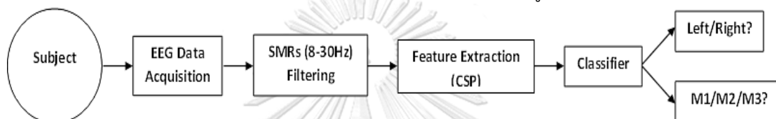
รูปที่ 21 กระบวนการวิเคราะห์สัญญาณคลื่นไฟฟ้าสมอง
