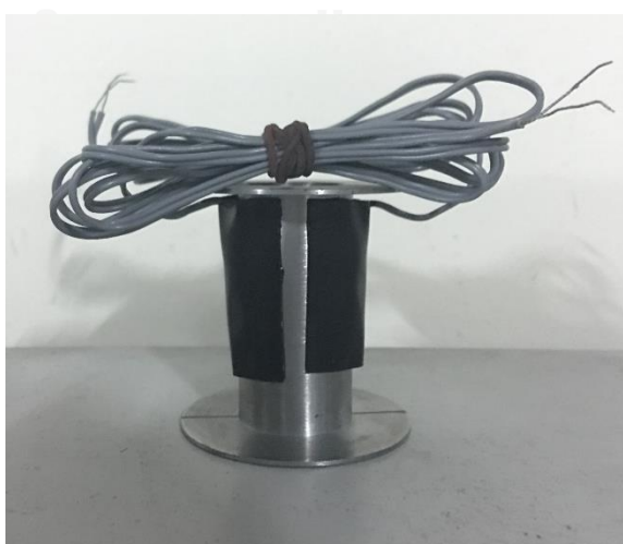
รูปที่ 3.5 Load cell ที่ติด Strain gages ทั้ง 2 ฝั่ง
