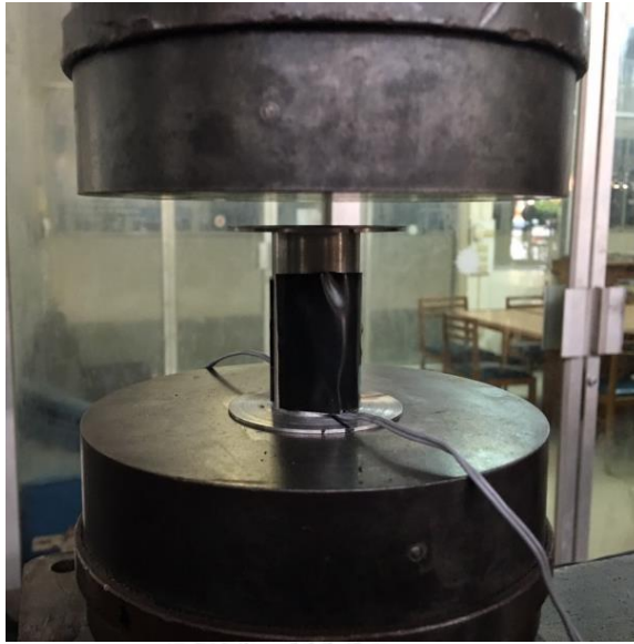
รูปที่ 3.6 การทดสอบ Load Cell
