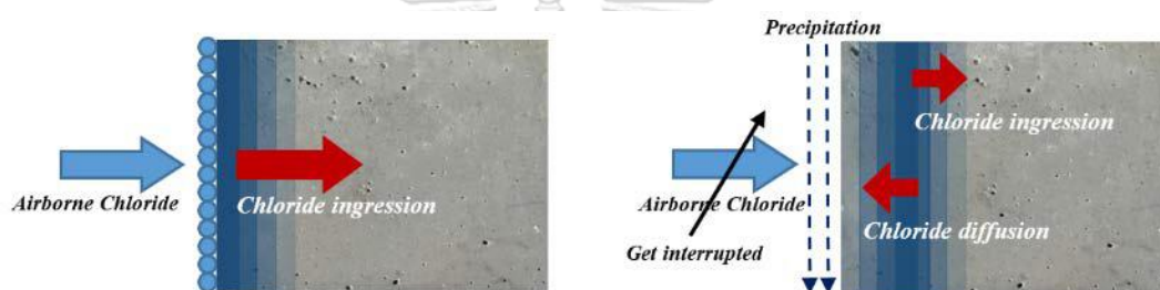
รูป 2-11 รูปแสดงการแพร่ย้อนกลับของอนุภาคคลอไรด์เมื่อถูกชะล้างโดยน้ำฝน
