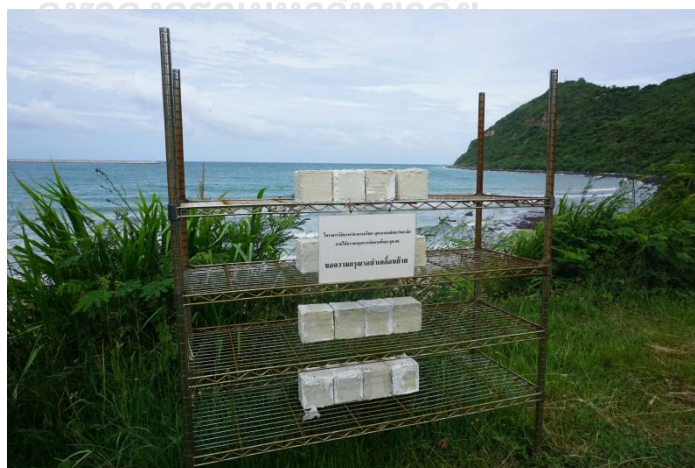
รูป 3-8 ชั้นวางสำหรับติดตั้งตัวอย่างมอร์ตาร์ในสถานที่จริง
