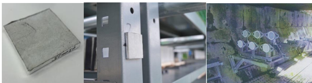
รูป 2-23 การดักเก็บปริมาณคลอไรด์โดยใช้แผ่นมอร์ต้า
