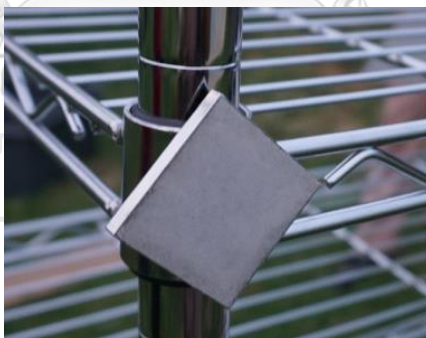
รูป 3-5 รูปตัวอย่างและการติดตั้งแผ่นมอร์ตาร์
