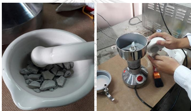
รูป 3-9 การบดตัวอย่างมอร์ตาร์ซีพเพื่อนำผงไปทดสอบ
