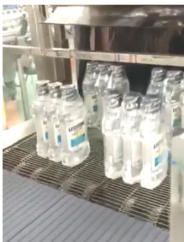
รูปที่ 3.5 ขั้นตอนการ shrink bundle
