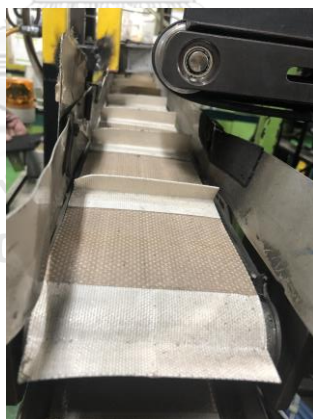
รูปที่ 5.21 รูปแบบรางลำเลียง Exhaust bulb ทีละหนึ่งหลอด
