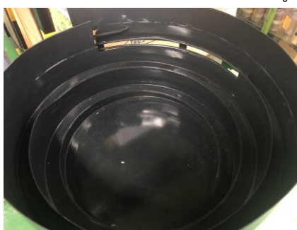
รูปที่ 5.16 หม้อ Feeder ที่ผ่านการเคลือบยางเรียบร้อยแล้ว
