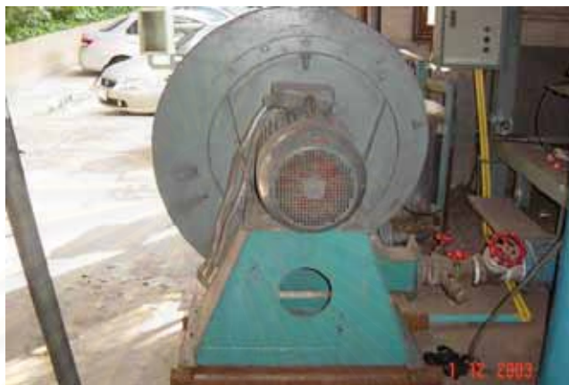
รูปที่ 3.5 เครื่องเป่าอากาศ (Air blower)
