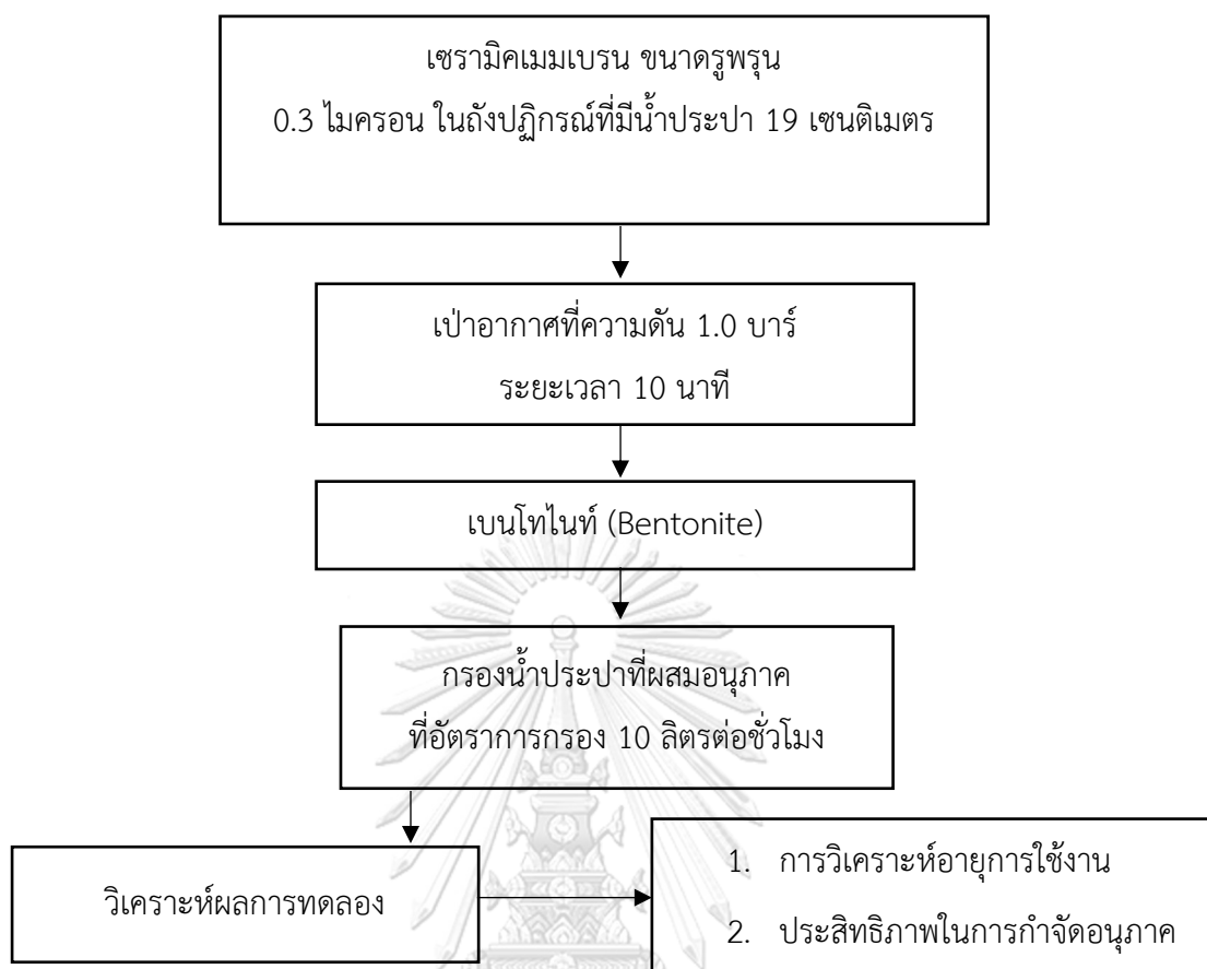
ภาพที่ 3-13 แผนผังการทดสอบประสิทธิภาพการกรองของเซรามิกเมมเบรน
