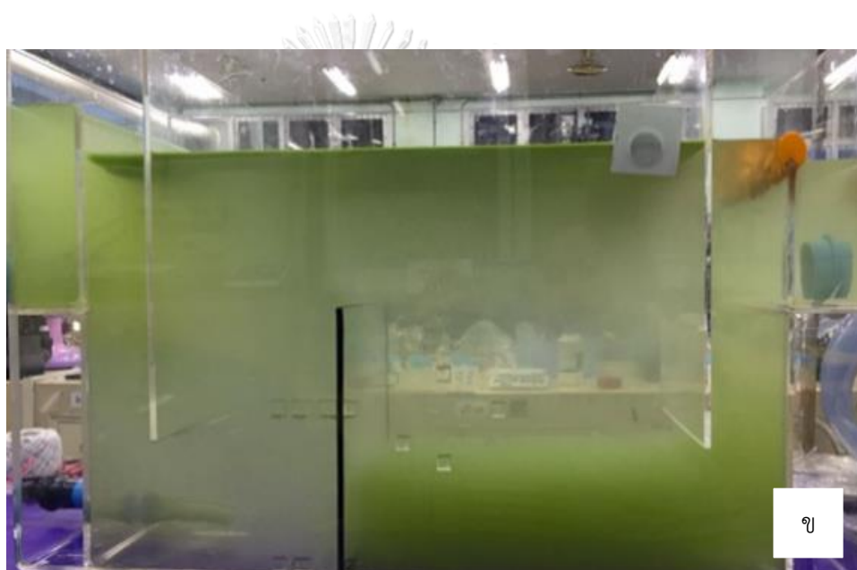
รูปที่ 4-64 ถังลอยตะกอนการทำให้ลอยด้วยอากาศละลายหลังเดินระบบกระบวนการทำให้ลอยโดยใช้ น้ำดิบจริงจากสระมรกตความเข้มข้นสาหร่าย 3 \times 10^6 เซลล์/มิลลิลิตร (ก) บริเวณผิวหน้า และ (ข) บริเวณด้านข้างของถังปฏิกริยา
