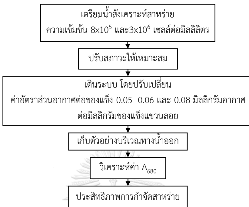
รูปที่ 3-13 การเดินระบบการทำให้ลอยด้วยอากาศละลาย
