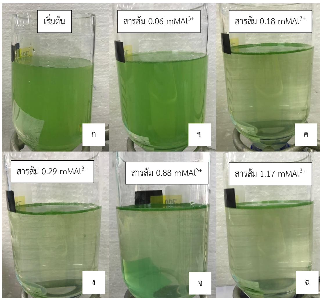
รูปที่ 4-12 ลักษณะน้ำหลักผ่านการแยกสารละลายความเข้มข้น 3 \times 10^6 เซลล์/มิลลิลิตร ของอุปกรณ์ทดสอบการลอยตัว (ก) เริ่มต้น (ข) หลังการทำให้ลอยร่วมกับเติมสารส้ม 0.06 (ค) 0.18 (ง) 0.29 (จ) 0.88 และ (ฉ) 1.17 มิลลิโมลาร์อะลูมิเนียม
