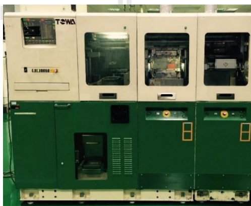
รูปที่ 23 เครื่องขึ้นรูปบรรจุภัณฑ์ (Molding Machine)
