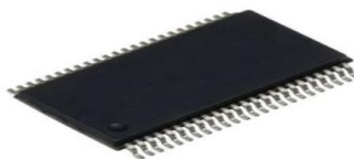
รูปที่ 50 ชิ้นงานที่มองไม่เห็นความเสียหายภายนอก
