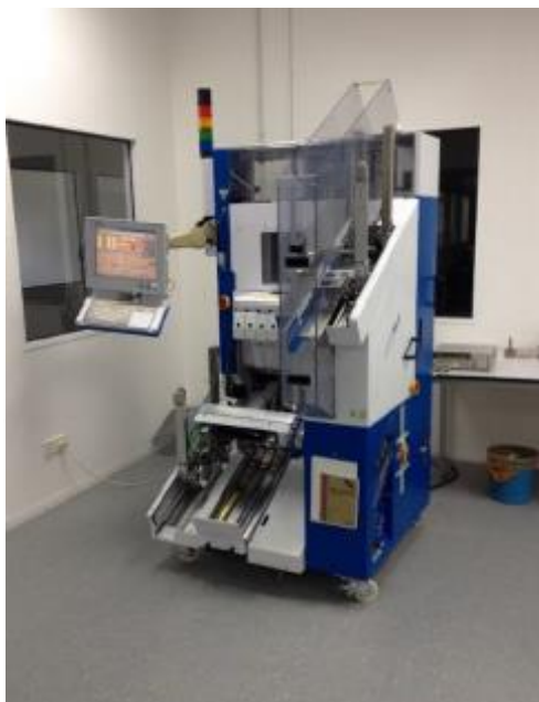
รูปที่ 42 เครื่องจับงาน (Handler)
