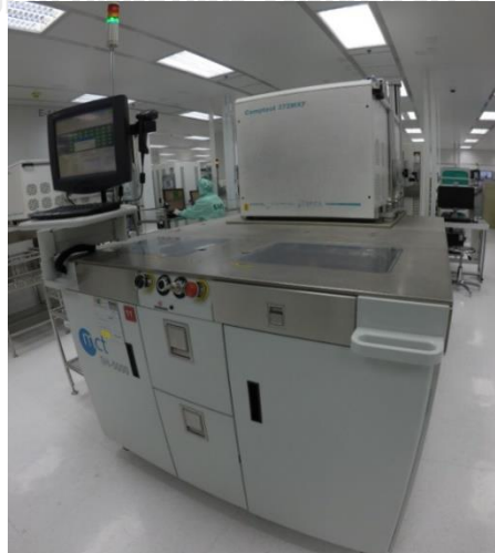
รูปที่ 57 กระบวนการทดสอบแผงวงจรรวมด้วยเครื่องจักรที่ถูกคัดเลือกหลังการปรับปรุง
