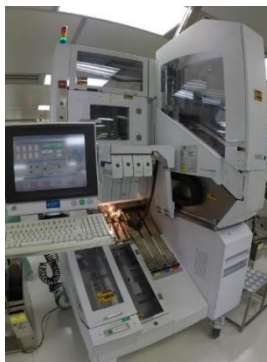
รูปที่ 25 เครื่องจับชิ้นงานและจัดตำแหน่งชิ้นงาน (Handler)
