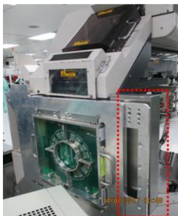
รูปที่ 48 ตัวยึดเครื่องจับงานและเครื่องทดสอบ (TDI docking)
