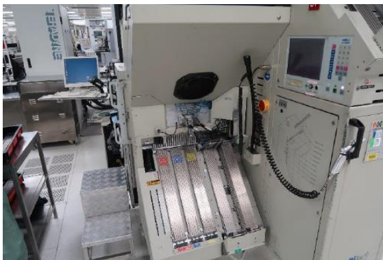
รูปที่ 29 ส่วนที่รับชิ้นงานออกแยกงานดีและงานเสีย (OUTPUT MAGAZINE)
